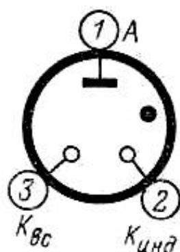
Линейный индикатор тлеющего разряда для непрерывного контроля в устройствах индикации и сигнализации.
