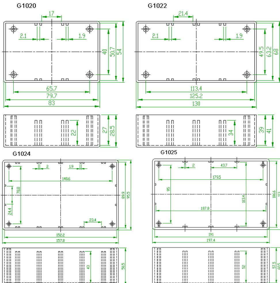
Крышки для корпусов серии G102x с крепежным фланцем:
