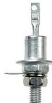
Стабилитроны серии Д816 кремниевые, диффузионно-сплавные, средней мощности.
