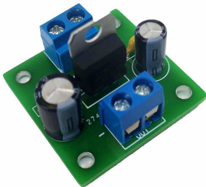
Понижающий стабилизатор напряжения (до 9в 1А)
