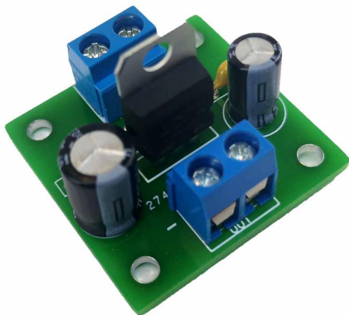
Понижающий стабилизатор напряжения (до 12в 1А)
