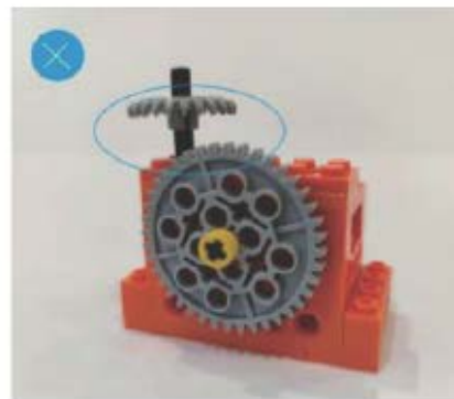
Большое расстояние между шестернями. Нет зацепления
