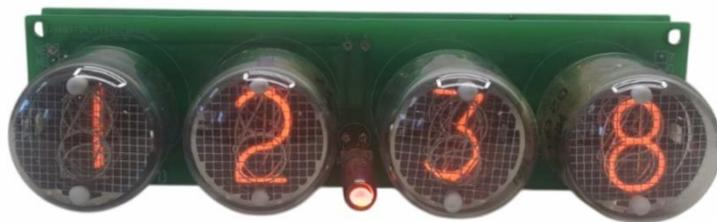
**Ламповые часы на газоразрядных индикаторах ИН-4 (без ламп и корпуса)**
