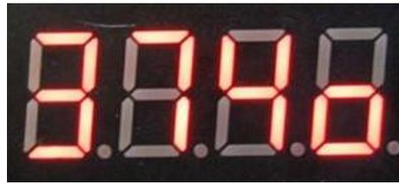
Если вы пытались проверить микросхему в режиме AUTO TEST и она неисправна (или отсутствует), то результат будет следующим:
