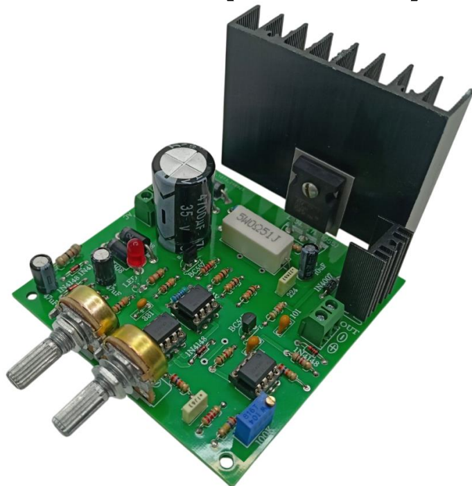
Регулируемый блок питания 0-30V 3A.
