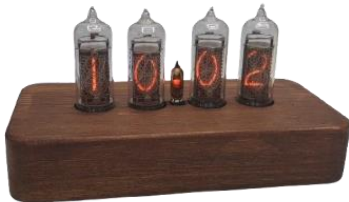
Индикатор времени «Ламповые часы» на газоразрядных лампах ИН-14
