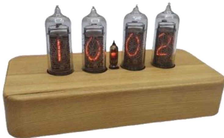
Индикатор времени «Ламповые часы» на газоразрядных лампах ИН-14
