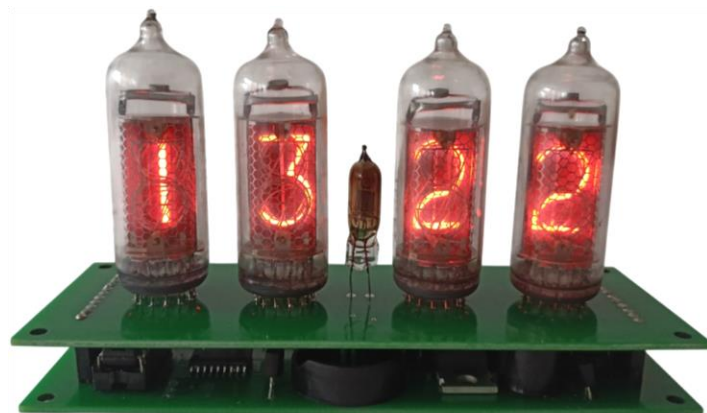
МОДУЛЬ ИНДИКАЦИИ ВРЕМЕНИ на газоразрядных индикаторах ИН-14 (микроконтроллер SO-18)
