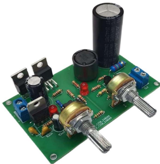
Лабораторный блок питания с регулировкой выходного напряжения 0-30В и тока 0-3А.
