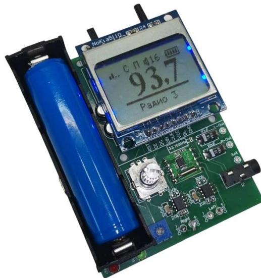
**FM радиоприёмник на микросхеме-
