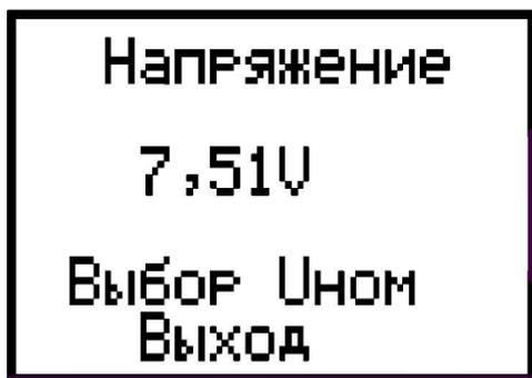
Для правильного отображения заряда батареи необходимо настроить измеритель напряжения, входящий в состав приёмника. Для входа в меню настройки измерителя напряжения нужно перед включением питания нажать кнопку энкодера и удерживать её до тех пор, пока на экране дисплея не появится информация, показанная на рис. слева. В верхних строках указывается измеренное напряжение аккумулятора. Посередине экрана выводится номинальное напряжение батареи. В нижних строках выводятся строки управляющего меню.
