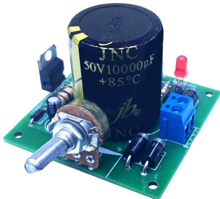
Регулируемый блок питания до 30 вольт 3А
