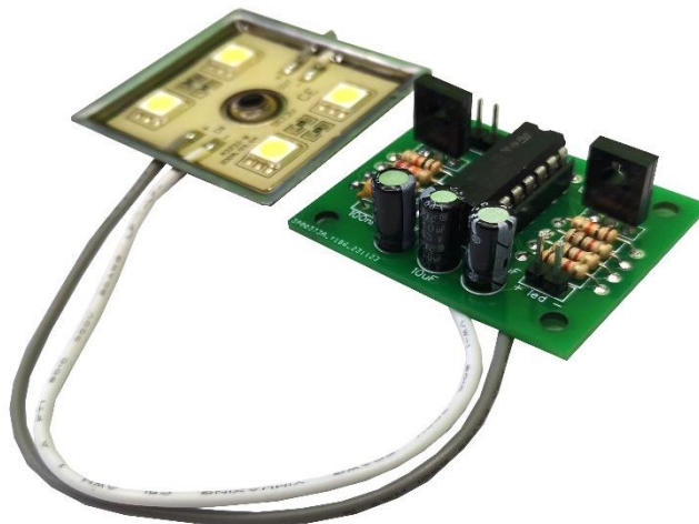
Простая сирена с мигалкой на микросхеме NE556
