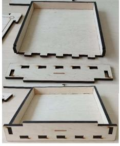
2. Возьмите основание выдвижного ящика (оно имеет зубцы со всех сторон) и приставьте к нему стенки (стенки выдвижного ящика меньше по высоте). Нанесите клей на зубцы и поставьте стенки так, как показано на изображении, воспользуйтесь молярной лентой для фиксации. Когда стенки зафиксируются, прикрепите к ним лицевую сторону ящика. Учтите, что пазы могут вставляться туго.
