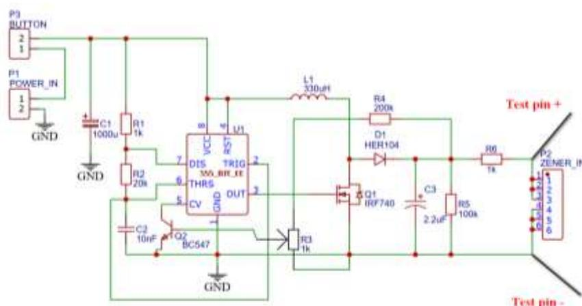
**Внимание!** На выходе устройства присутствует напряжение до 150 вольт. После сборки обязательно отмойте флюс.
