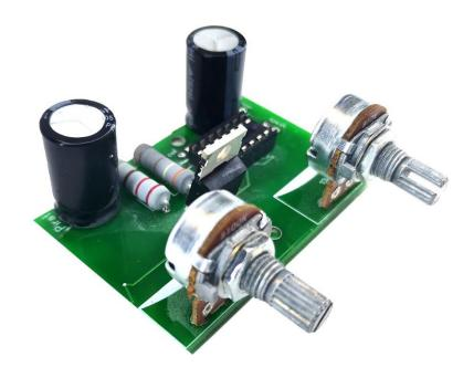
Пират – это импульсный металлоискатель с простой и доступной для повторения схемой. Металлоискатель содержит небольшое количество элементов и простую для изготовления поисковую катушку. С катушкой 280 мм, пират будит видеть монеты до 20см, а крупный металл до 1,5 метра.
