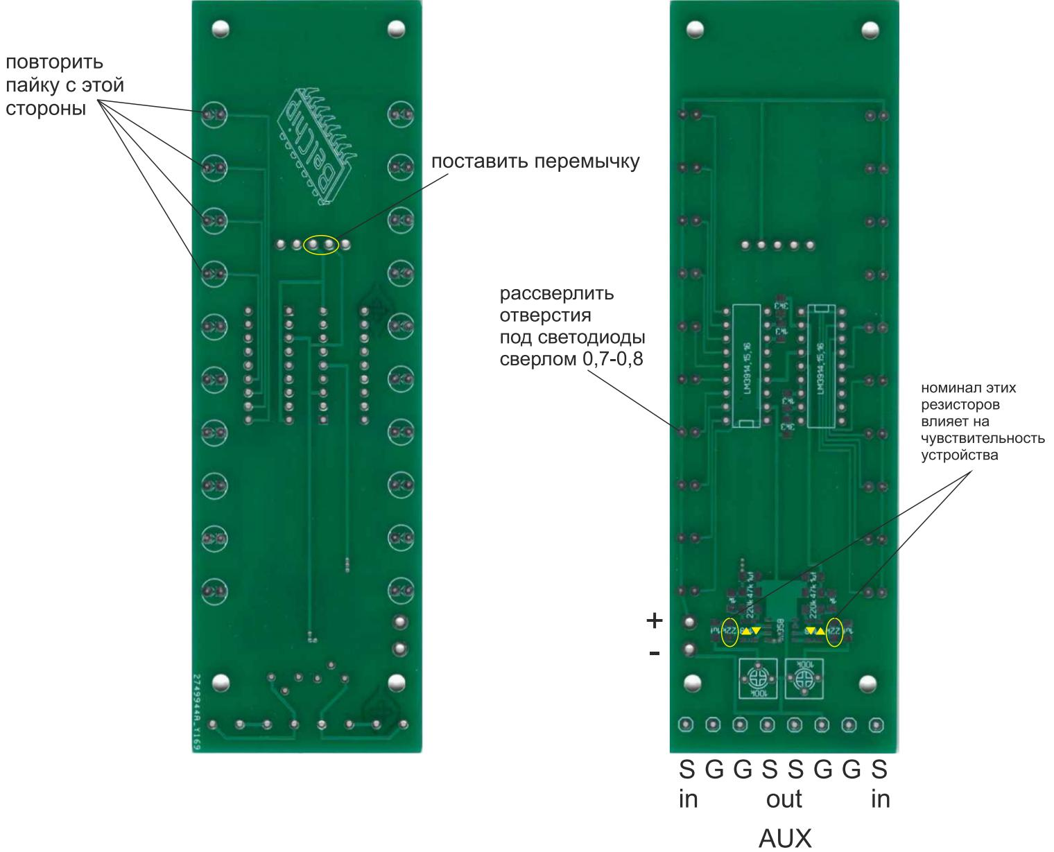
В случае невозможности рассверлить отверстия, откусить ножки светодиодов (предварительно запомнив полярность) и напаять их непосредственно на контактные площадки.
