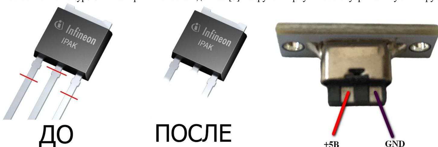
установки необходимо сначала вставить разъём в деталь [7] корпуса, а затем припаять к нему провода.
