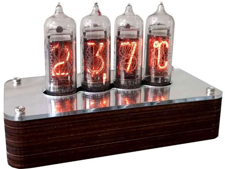
Ламповый термометр на газоразрядных индикаторах ИН-14, ИН-19А
