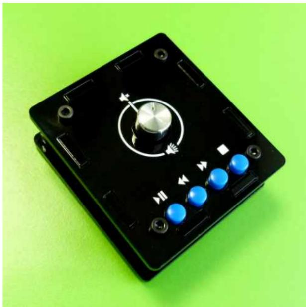
Набор для сборки контроллера для управления стандартными и браузерными мультимедиа плеерами. Устройство подключается в USB разъем компьютера/ноутбука и содержит регуляторы управления громкостью звука, воспроизведения и выбора дорожки.
