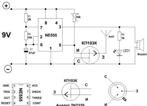
После сборки прибора проверяем его работу, при приближении его к проводу начинает генерировать импульсы микросхема NE555 и в пищалке появляются короткие сигналы, частота которых увеличивается по мере приближения к сетевому проводу, вместе со звуковыми сигналами также в такт мигает светодиод.
