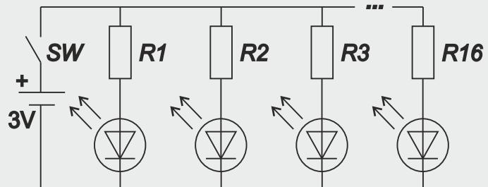
На рисунке представлен вариант питания от двух пальчиковых батареек. Все светодиоды подключены параллельно, каждый через резистор, номинал которого вы можете выбрать самостоятельно из комплекта.
