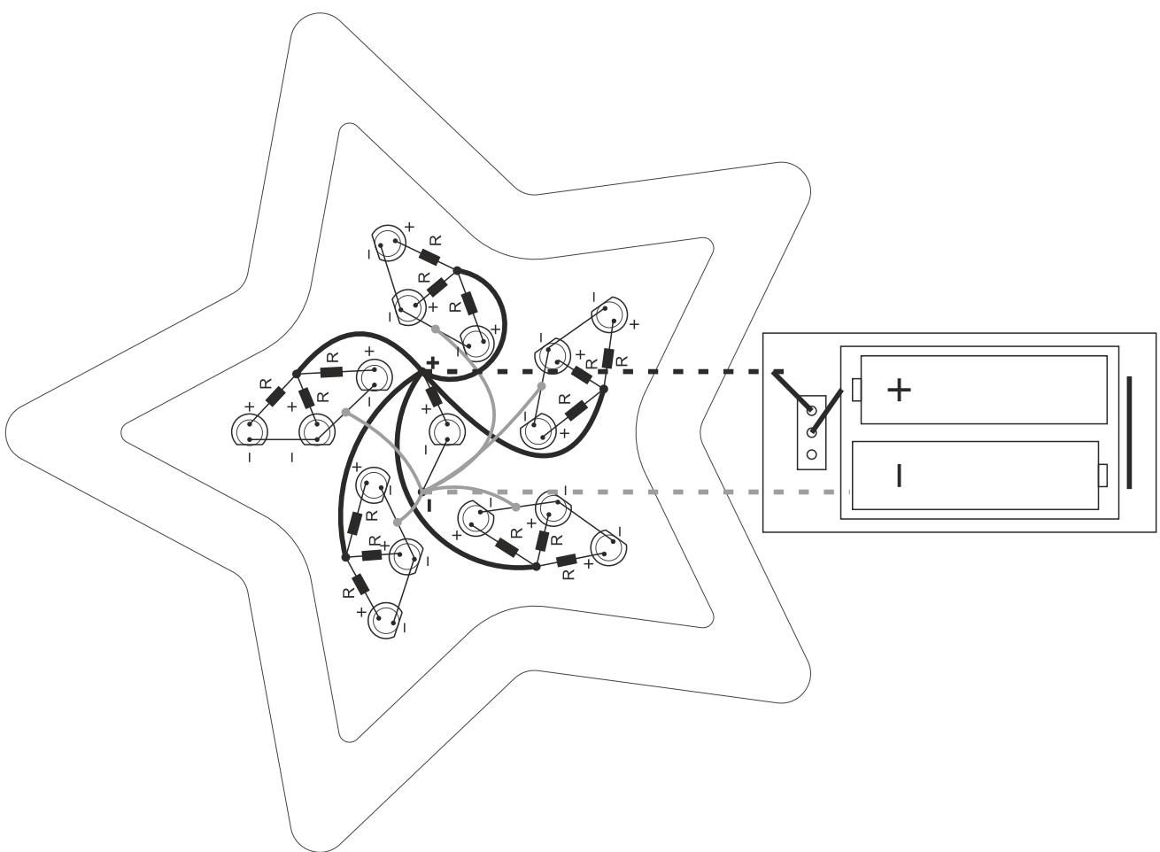
Разогните выводы светодиодов согласно распайке, припаяйте резисторы к плюсовым выводам светодиодов.
