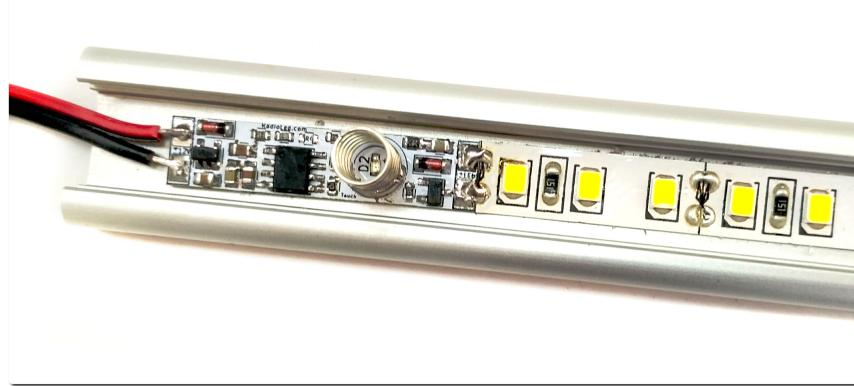
На фото приведен пример подключения димера M292-20Y. При подключении с помощью пайки провода от блока питания подводятся к контактам {GND/12V}, а лента — к контактам {LED-/LED+} соответственно.
