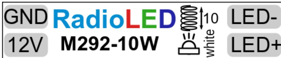
\* Несмотря на то, что маркировка «12V» используется для обозначения «плюса» подключаемого блока питания, модули M291, M292 могут использоваться и с блоками питания на 24В, если применяется светодиодная лента на 24В.
