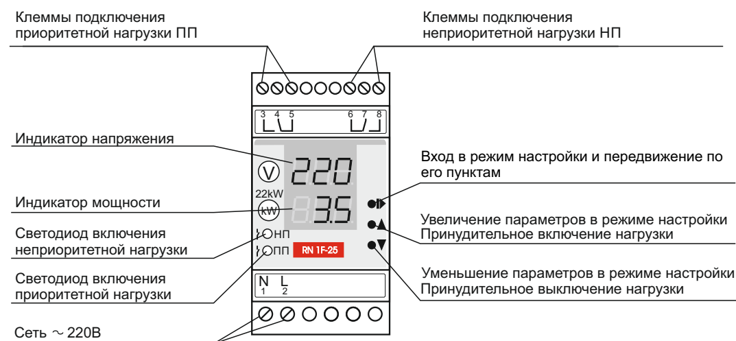
Рис. 1. Устройство прибора
