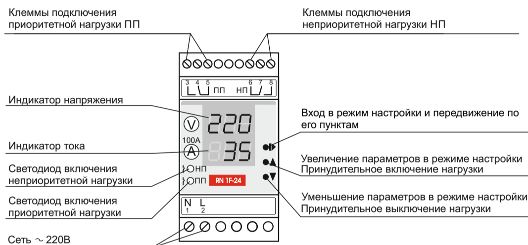
Рис. 1. Устройство прибора
