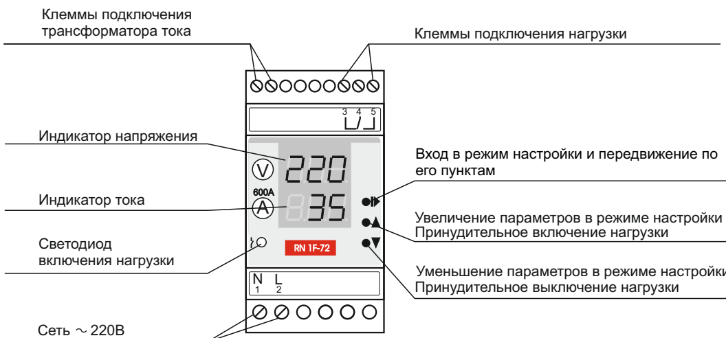
Рис. 1. Устройство прибора
