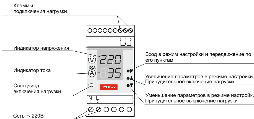
Рис. 1. Устройство прибора
