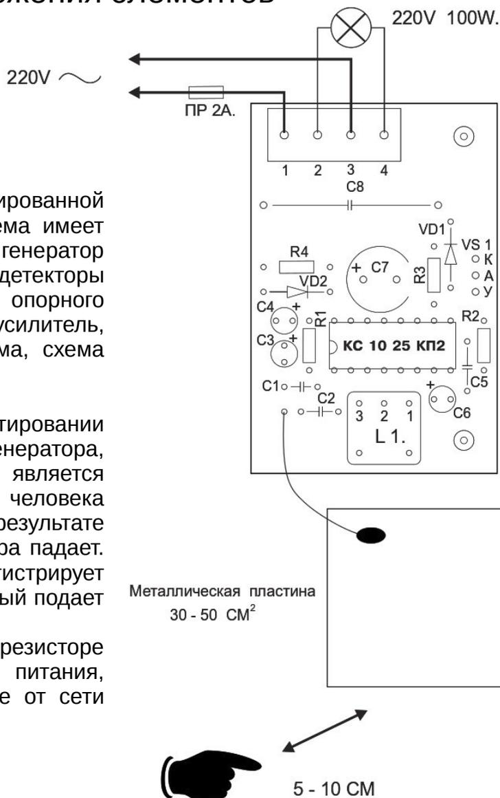
После монтажа устройства в корпус, а также после изменения размеров датчика необходимо подстроить катушку L1 для желаемой чувствительности срабатывания схемы. В некоторых случаях может потребоваться подбор конденсатора C2. Настройку желательно производить при малой ёмкости C6-10 мкф. Ёмкость конденсатора C6 влияет на время открывания и закрывания симистора VS1.
