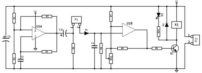
**Настройка схемы:** резистором RV1 добиться однозначности срабатывания схемы при погруженных в воду контактах датчика.
