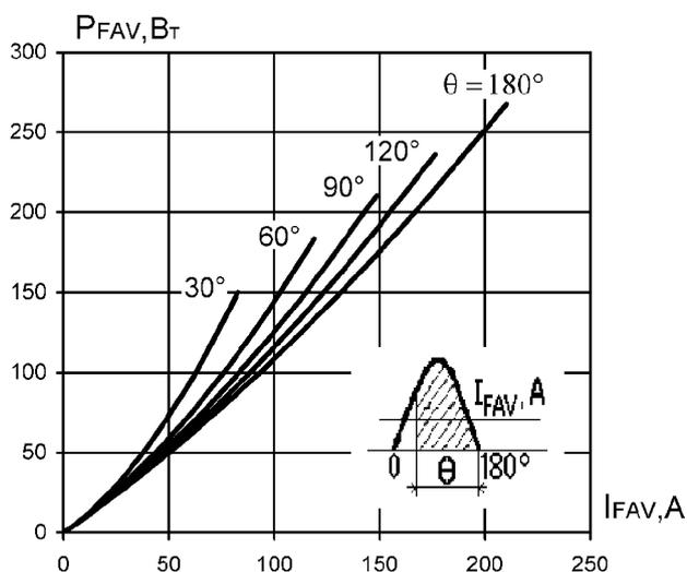
Рис. 3. Средняя мощность прямых потерь (однополупериодный синусоидальный импульс)
