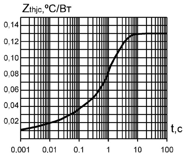
Рис. 2. Переходное тепловое сопротивление переход-корпус ( постоянный ток )
