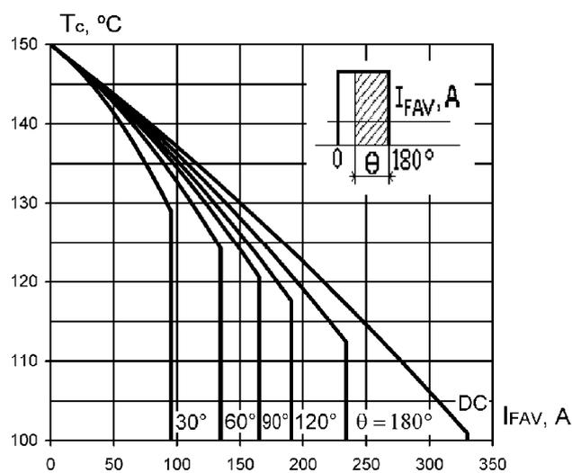
Рис. 6. Максимально допустимая температура корпуса (прямоугольный импульс)
