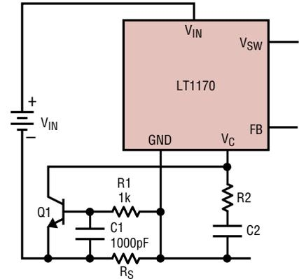
NOTE THAT THE LT1170 GND PIN IS NO LONGER COMMON TO  $V_{IN}$ .
