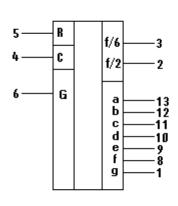
Микросхема собой представляет десятичный счётчик с выходом на семисегментные индикаторы. На вход С частота. подаётся тактовая асинхронный сигнал сброса с активным высоким уровнем. На вход С подают модулирующую импульсную последовательность с частотой 32 или 64 необходимый для электролюминисцентных или жидкокристаллических индикаторов. С выхода 3 снимается частота в четыре раза ниже тактовой, а с выхода 2 в 10 раз ниже тактовой.
