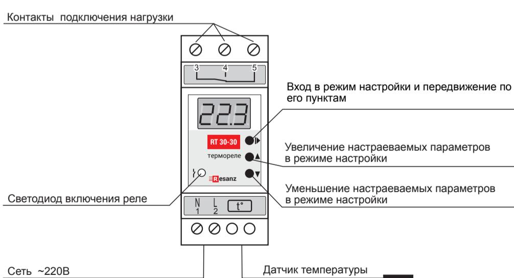
Рис. 1: устройство прибора
