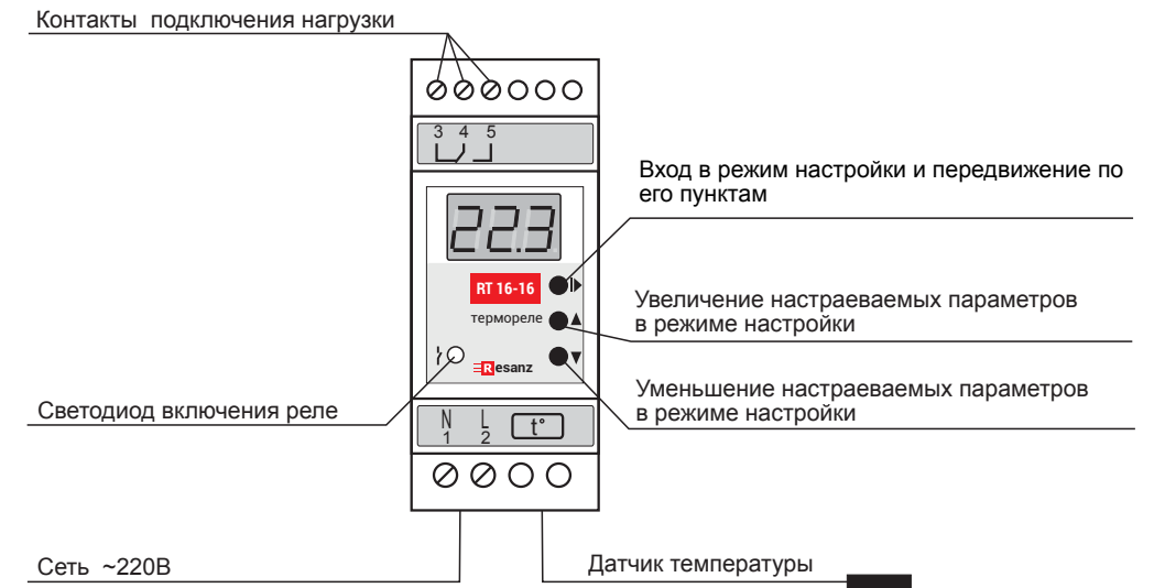
Рис. 1: устройство прибора
