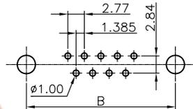
RECOMMEND PCB LAYOUT(TOLERANCE  $\pm 0.05$ )
