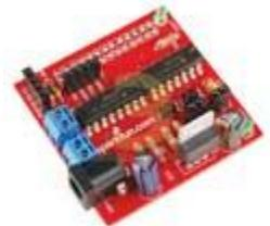
Драйвер моторов RaspiRobot для Raspberry Pi
