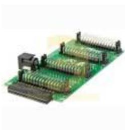
Плата расширения PIFACE - PI RACK FOR RASPBERRY PI
