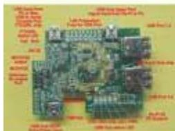
4-х портовый USB хаб, RTC, ЦАП, датчик температуры и USB консоль для Raspberry Pi
