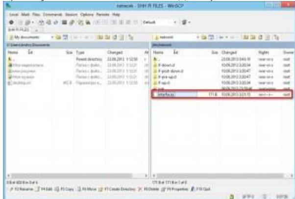
2) Выделяем файл и открываем его для редактирования (клавиша "F4"). И вместо строки "iface eth0 inet dhcp"
